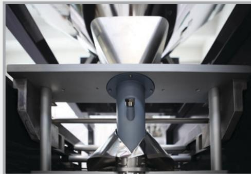
• Particolare del tubo conformatore.
